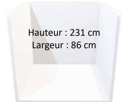
**SCHÉMA 2 : ZONE DE RÉSERVATION DE TRAVAIL POUR UN TWIDO AVEC FINITION**
