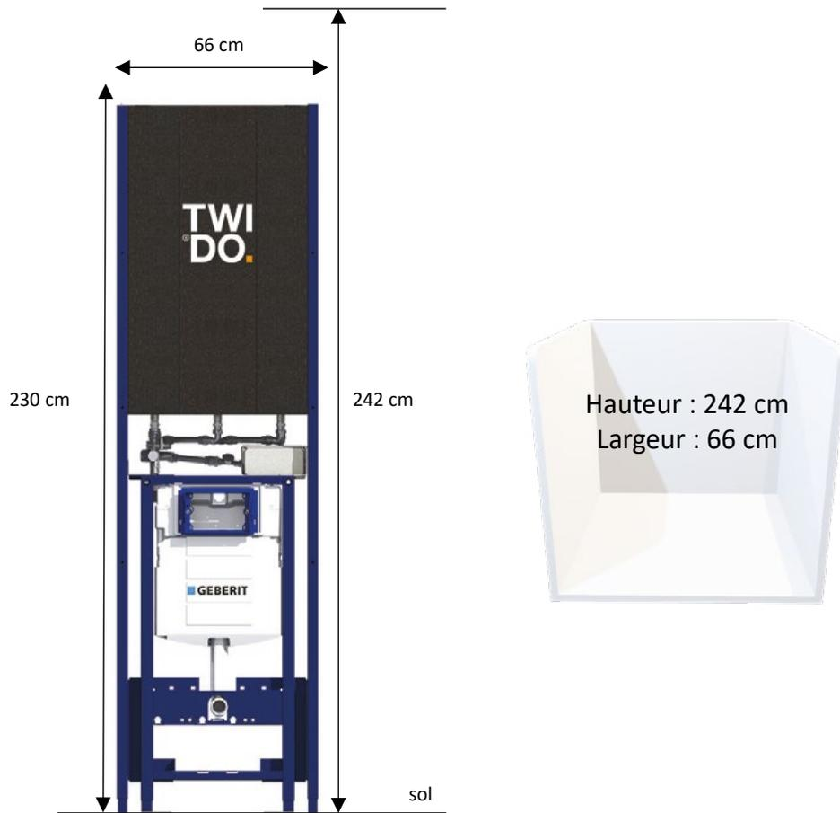
Espace nécessaire à la pose du Twido avec démontage\* : les équerres peuvent être vissées au travers du châssis, une marge de 1cm est suffisante.
