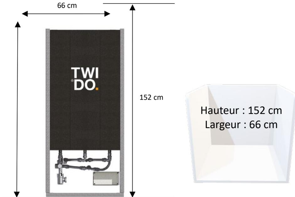
Espace nécessaire à la pose du Twido avec démontage\* : les équerres peuvent être vissées au travers du châssis, une marge de 1cm est suffisante.
