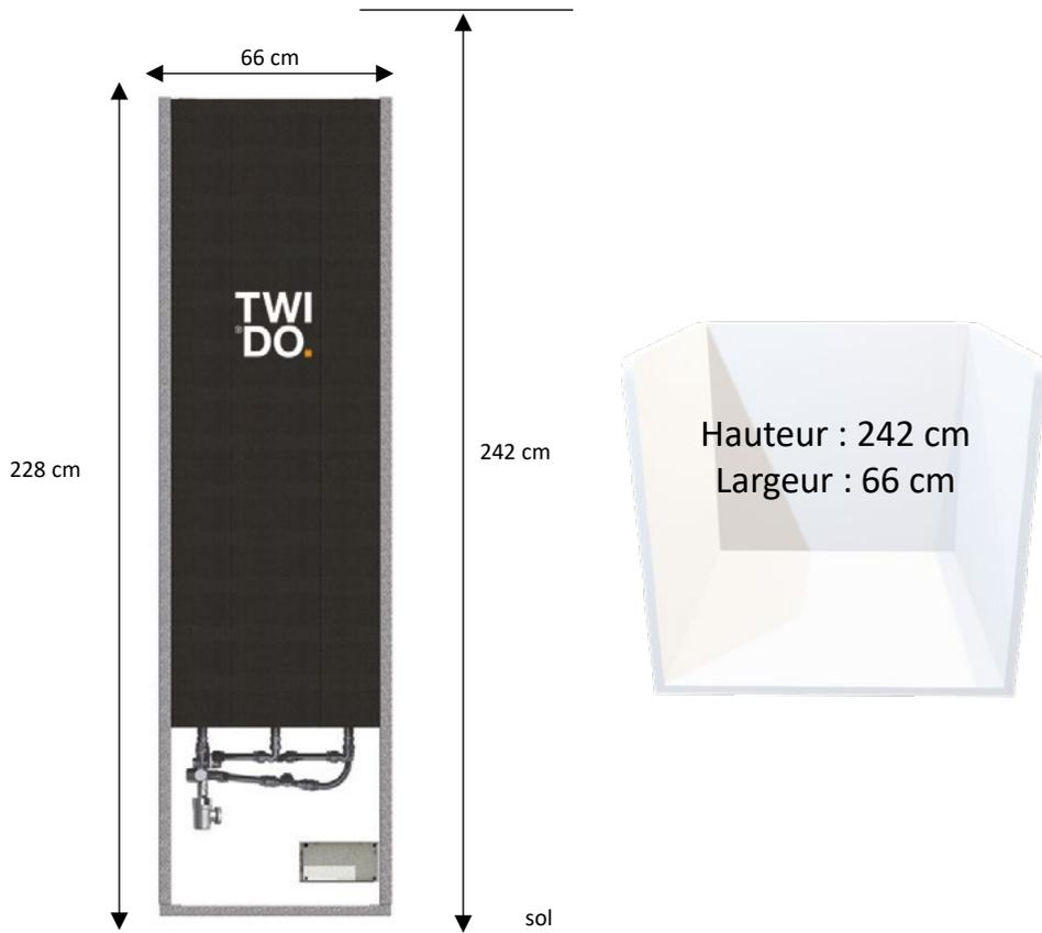
Espace nécessaire à la pose du Twido avec démontage\* : les équerres peuvent être vissées au travers du châssis, une marge de 1cm est suffisante.
