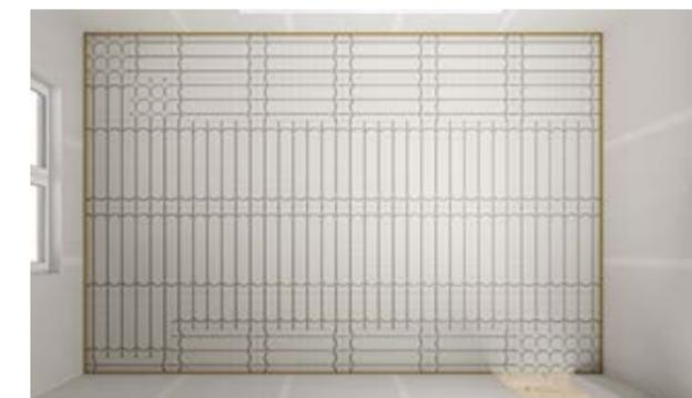
\*schéma d'installation avec deux boucles de chauffage
